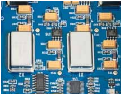
Oben: Gleich zwei präzise Quarz-Clocks übernehmen die Taktung des Scorpio. Das sind die Bauteile mit den silbernen Abdeckkappen
