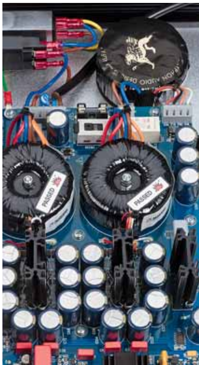
Unten: Den Stellenwert der Stromversorgung für den Klang kennt man bei Gryphon seit Langem. Ihren Player versorgen die Dänen aus drei kompletten Netzteilen. Die für die Analogkreise sind zudem aufwändig stabilisiert
