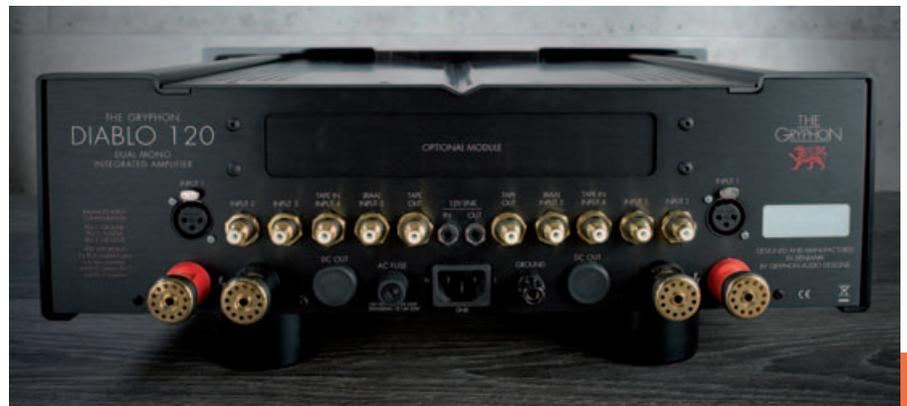
**SCHLITZ IM RÜCKEN:** Das Fach oberhalb der Cinch-Ports ist ein Steckplatz. Hier kann wahlweise ein Phono-Modul oder ein Digital/Analog-Wandler angedockt werden.
