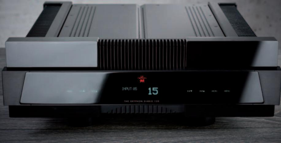
**VERSAMMELTE KRAFT:** Brandneu tritt der Vollverstärker Diablo 120 an – seine Schaltung arbeitet ohne Gegenkopplung und stemmt bis zu 120 Watt an 8 Ohm.
